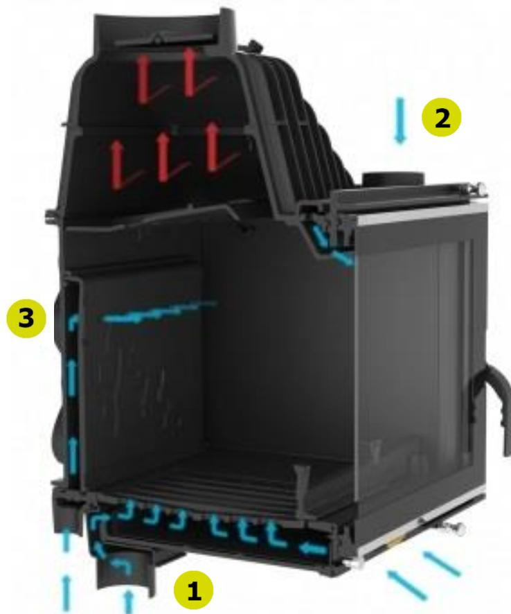
Подача воздуха в топочную камеру каминных топок Kawmet распределяется на три потока:
